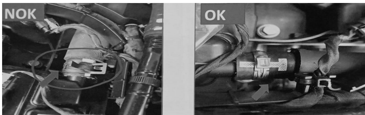
1.3 сурет - Пайдаланылған газ құбырының қысқышының дұрыс орнатылмауы.
